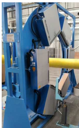
3-achsiges ODAC 550 System misst ein Offshore Kabel von 500 mm Aussendurchmesser
