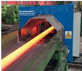
SPS 200-S4 Mesure de différents profilés en forme de L, laminés à chaud.
