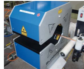
PMM 80-4K Mesure des profilés en acier étirés de différentes formes.
