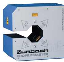
PMM 30/50/80-4K Campos de medição: dentro de Ø 30/50/80 mm
