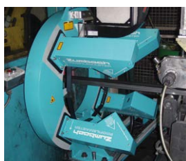
SPS 140-N4 Medição de perfis com formato redondo e especial.
