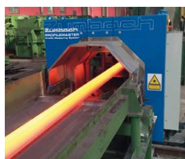
SPS 200-S4 Medição de diferentes perfis em forma de L, laminados a quente.
