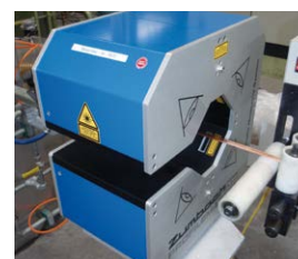
PMM 80-4K Medição de diferentes formatos de perfis de aço trefilado.
