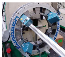
PMM 140D-4A Medição de perfis para portas ou janelas.
