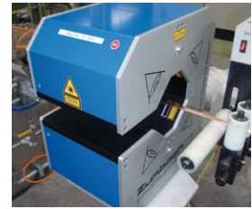
PMM 80-4K Измерение различных форм производимого стального профиля.
