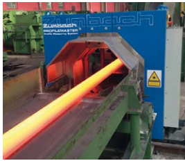
SPS 200-S4 Измерение различных горячекатаных L-образных профилей.
