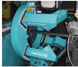
SPS 140-N4 Измерение круглых и специальных фасонных профилей.
