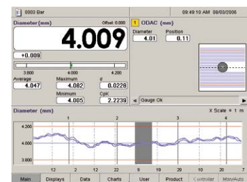
Процесс прокатки и другие процессы: средний диаметр, сводка статистических данных, основные технические данные, представленные на ленточных диаграммах
